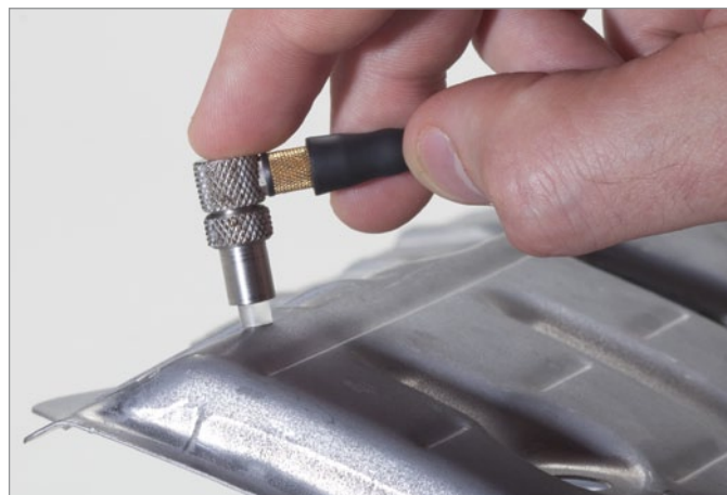
Измерение утонения металла после формования.
