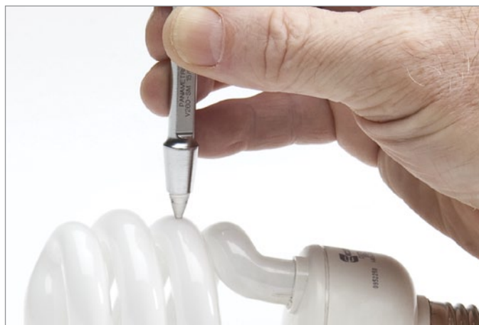
Измерение тонкого стекла с помощью преобразователя V260-SM Sonopen®
