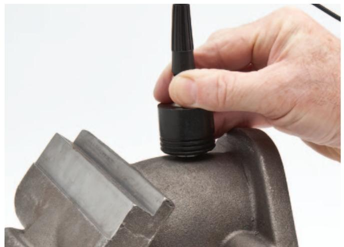
Дополнительное программное обеспечение с повышенным проникновением сигнала позволяет измерять толщину массивных литых деталей или материалов с высоким затуханием звукового сигнала.
