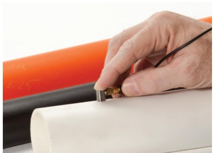
Измерение толщины различных материалов, включая пластмассу, металл, резину, стекло, керамику и композитные материалы.
